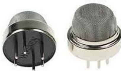
Fig: 3: Gas Sensor
